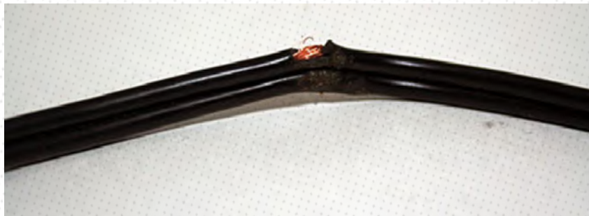
ภาพที่ 7 การตรวจสอบฉนวนชำรุด : ที่มาของภาพ โดย www.thai-electricworks.com
