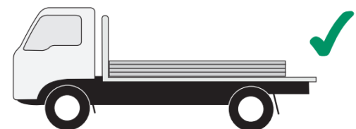
ภาพที่ 3-25 น้ำหนักบรรทุกที่ยาวเท่ากับรถ หรือรถที่ยาวกว่า โดยไม่มีส่วนยื่นด้านหลัง
