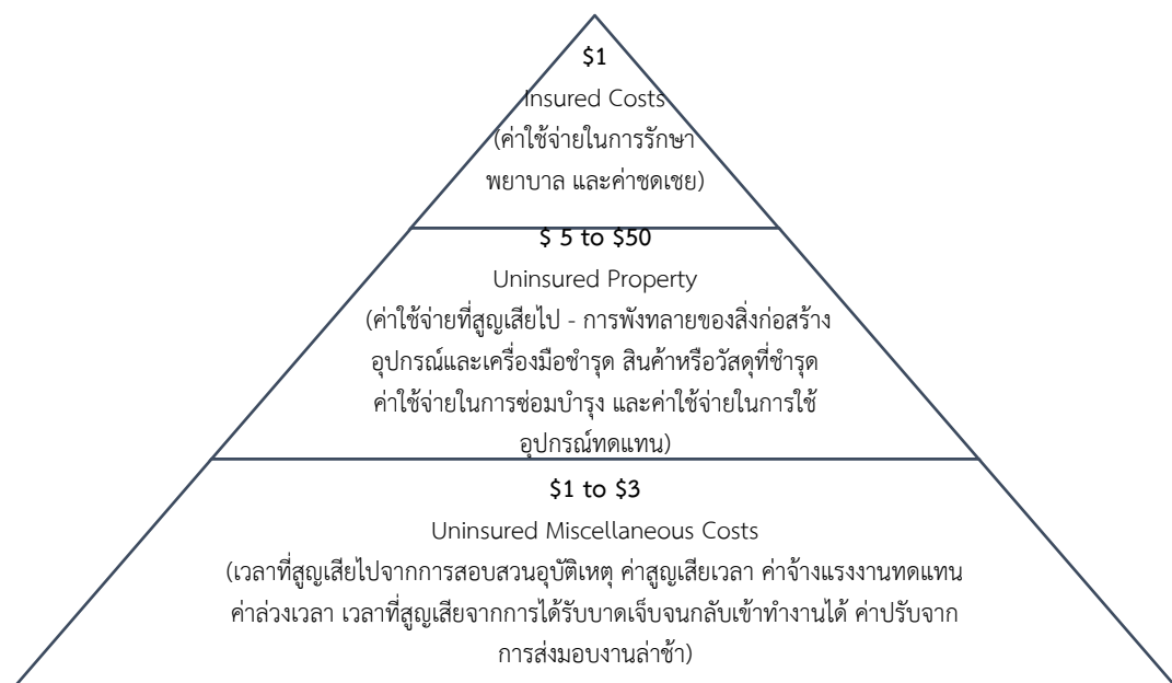
ภาพที่ 2-4 ความสูญเสีย (Adapted from Practical Loss Control Leadership (Bird Jr & Germain, 1986)
