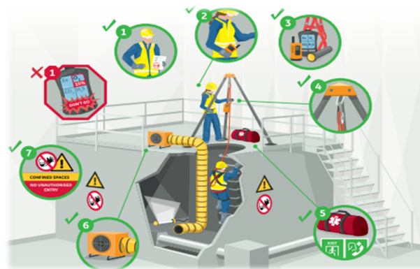
ตัวอย่างการจัดการอย่างปลอดภัยในการทำงานในที่อับอากาศ
